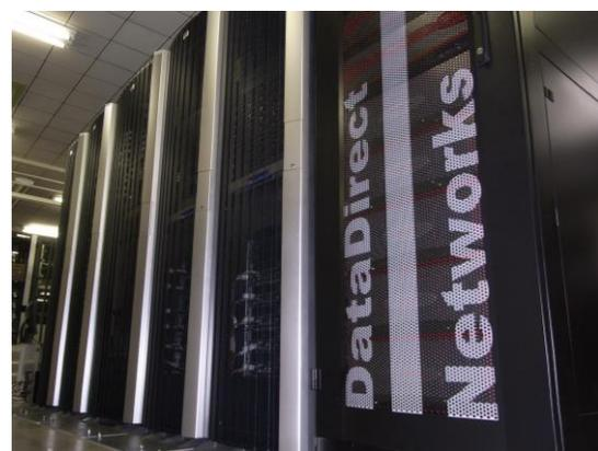
格子場の量子論のモンテカルロ計算に用いる計算機(128ノード、GPU搭載)。
