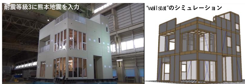
図1: 現代木造住宅の振動台実験とシミュレーションによる検討
